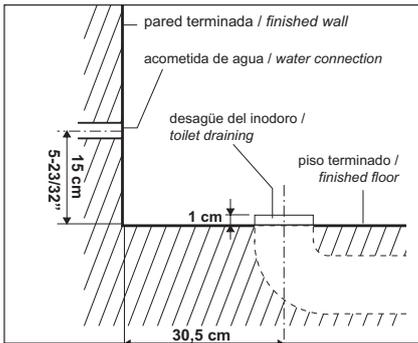
2. Verifique la alineación del inodoro respecto de la pared y marque en el piso los orificios para su fijación
