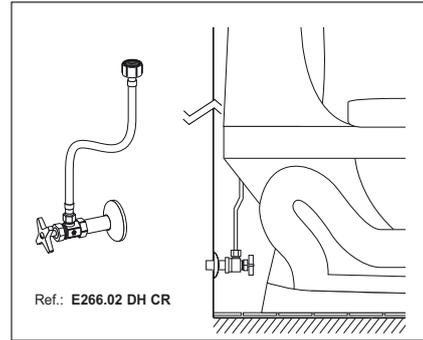
**IMPORTANTE:** Antes de conectar la válvula de entrada a la acometida de agua verifique que la tubería de alimentación esté limpia, libre de impurezas y residuos de construcción.
