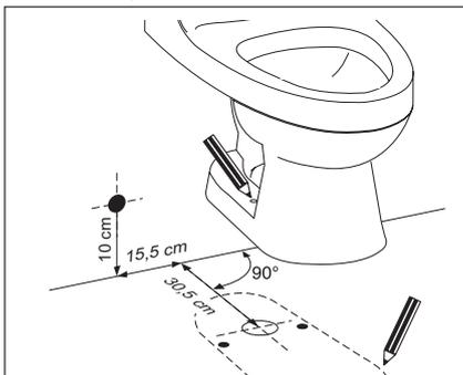
3. Retire el inodoro para perforar y colocar los tacos de fijación EPER-DH-BL (no incluidos) para fijar el inodoro al piso.
