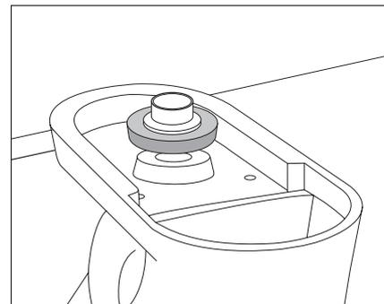
5. Coloque nuevamente el inodoro sobre el codo del desagüe, nivélelo y fíjelo al piso con los tirafondos.
